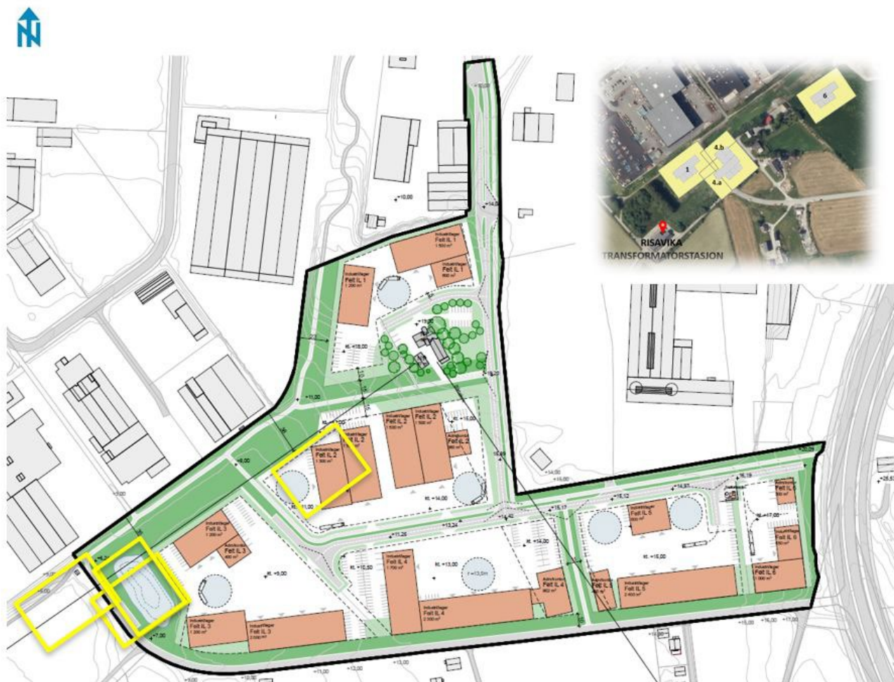
Figur 6-1 Utkast til illustrasjonsplan for utbygd næringsområde. (Ill: Aros Arkitekter). Multiconsult har tilføyd omtrentlig plassering av transformatorstasjon i utvidet næringsområde med gule rektangler.
