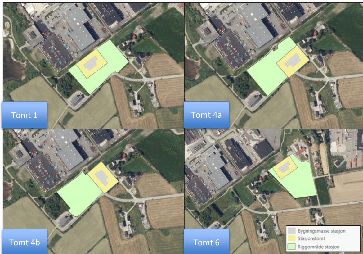
Figur 3-7 Skissert behov for midlertidig riggområde for de fire alternativene (grønt) (Ill: Lnett).
